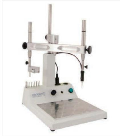
デンタグラフは、高精度な部分床義歯を作成するために必要な精度を提供します。
