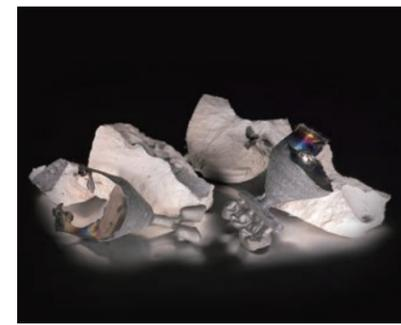
急速加熱及び従来のオーバーナイトにも対応している、チタン鋳造に最適な埋没材です。粒子が細かいので、鋳造体の表面が非常になめらかに仕上がります。
