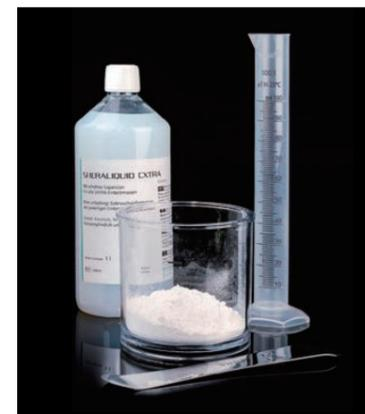
混水比を変えることにより膨張率を更にコントロールできます。
